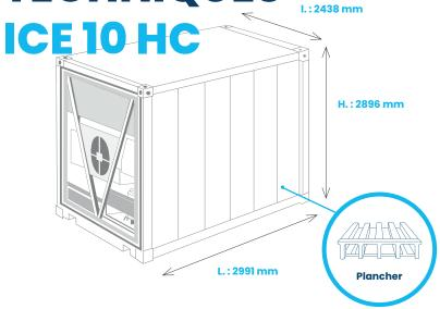
Données techniques Température Fluide frigorigène Structure
